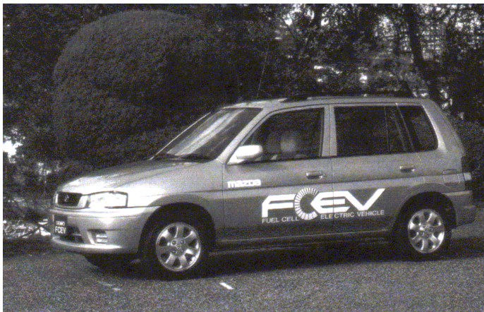
Figuur 11.10 Mazda's Demio FCEV voorgesteld in 1997. Het voertuig werd aangedreven door vier stacks (totaal vermogen van 20 kW) ontwikkeld door Mazda en bijgestaan door ultracondensatoren. Waterstof brandstof werd opgeslagen in een metaalhydride tanks.
