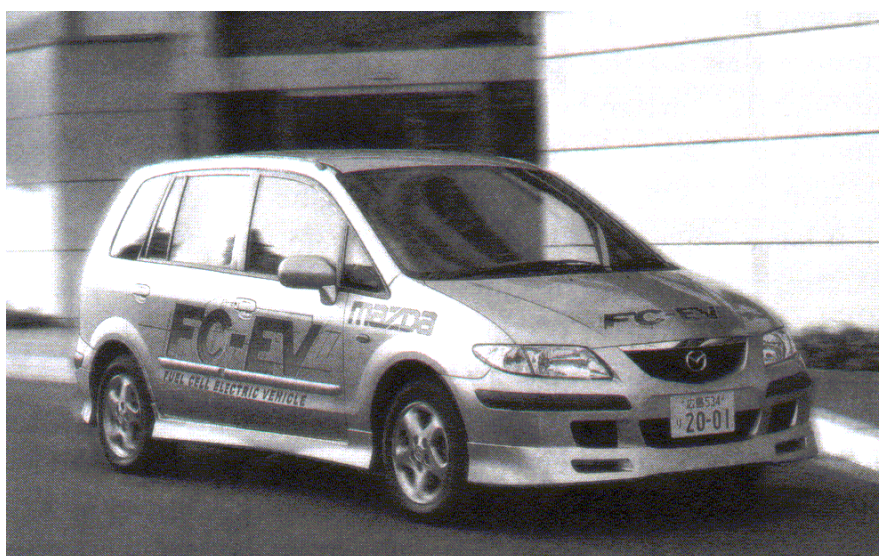
Figuur 11.11 Mazda's methanol-aangedreven Premancy FC-EV aangedreven door een Ballard Mark 900 series stack.
