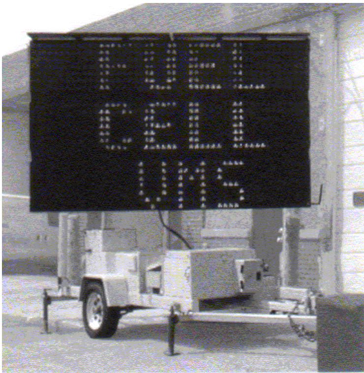
Figuur 10.9 Een veranderbaar verkeersbord met brandstofcel back-up vermogen van H Power.
