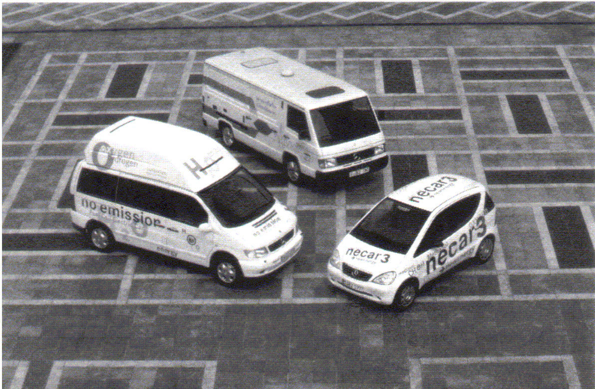
Figuur 11.5 DaimlerChryslers eerste drie brandstofcel-demonstratievoertuigen, de waterstof-aangedreven NeCar1 en 2, en NeCar 3 met een methanolreformer aan boord.
