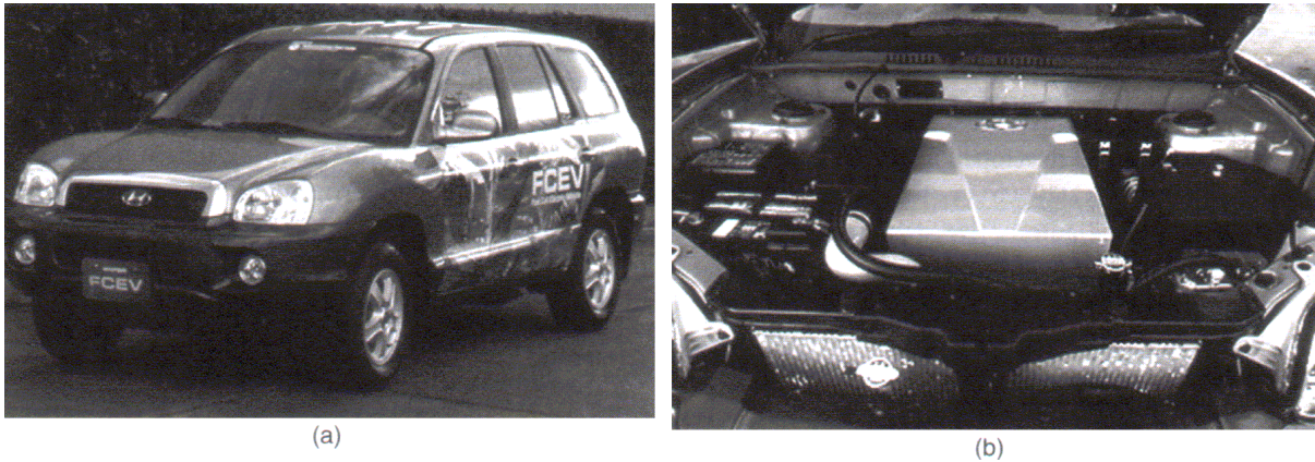
Figuur 11.18(a) Hyundai's Santa Fe brandstofcelvoertuig aangedreven door een UTC 75 kW-brandstofcel lopend op waterstof. (b) Een kijk onder de motorkap toont ons systeemintegratie. Merk op dat de brandstofcel niet onder de motorkap zit maar onder de achterbank in deze toepassing.
