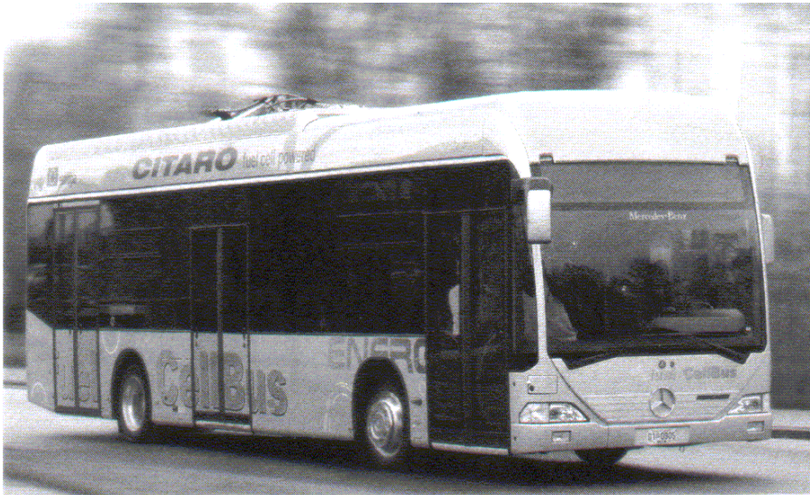
Figuur 11.14 De eerste Citaro bus met een brandstofcel vermogensysteem dat deelneemt aan rijexamens.
