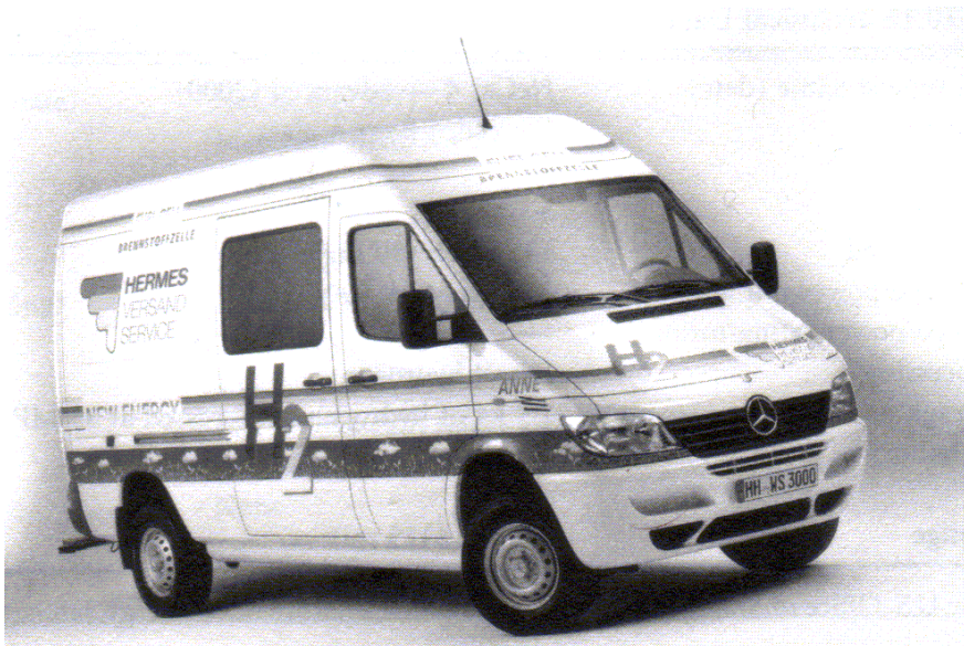
Figuur 11.7 Mercedes-Benz Sprinter: eerste transportwagen met brandstofcelstelsystemen.
